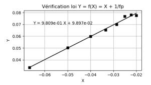
Chaque longueur est supposée déterminée par deux pointés de viseur de précision  $\Delta x$  connue, ce qui permet de calculer les incertitudes u(X) et u(Y) par relation de propagation pour chaque point. On construit ensuite N séries de points de mesure modifiés aléatoirement via des distributions uniformes. Pour chacune on obtient des paramètres de régression (a,b) différents que l'on stocke, afin de déterminer in fine leur moyenne et leur écart-type et de tracer leur histogramme.
